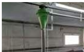
Cyclone de refoulement pour l'alimentation.
